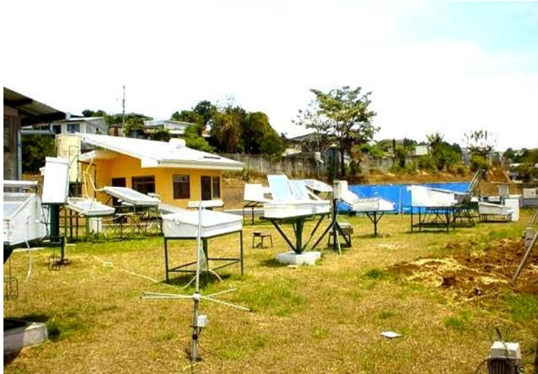
Figura 4: Patio Solar Experimental de la UNA, donde se realizaron muchas de las actividades de ACES tanto demostrativas y de investigación sobre usos y aplicaciones de la Energías Solar. Se observan diferentes dispositivos como: secadores, destiladores, cocinas, colectores térmicos, paneles fotovoltaicos, estanques solares, entre otros.
